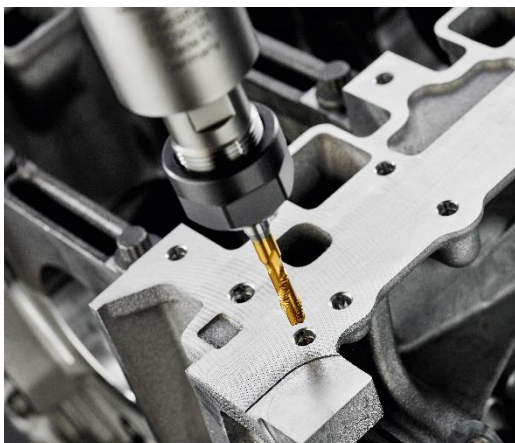
Bild 9: Die Punch Tap Technologie ermöglicht die Innengewinddefertigung in einem Viertel der Zeit.
