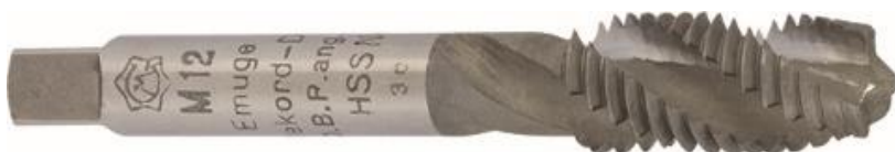
Bild 6: Der steilspiralgenutete Gewindebohrer wurde 1953 patentiert – bis heute stellt er die maßgebende Geometrie für die Innengewindefertigung in Grundlöchern dar.
